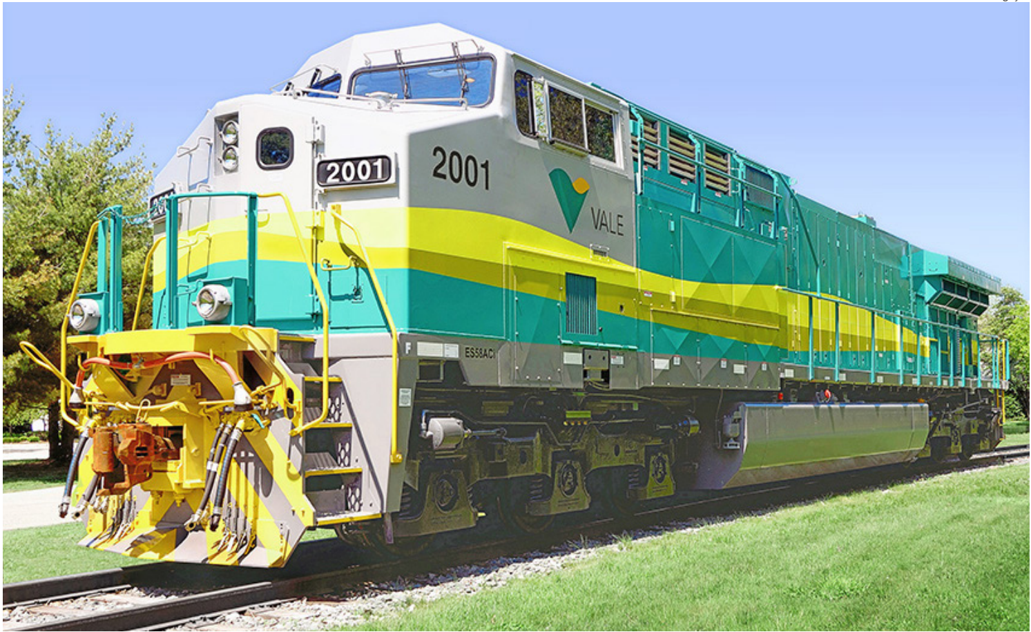
Locomotivas EVOBBW da Wabtec: essas máquinas estão entre as mais modernas do mercado e poderão operar com uma maior mistura de biodiesel
